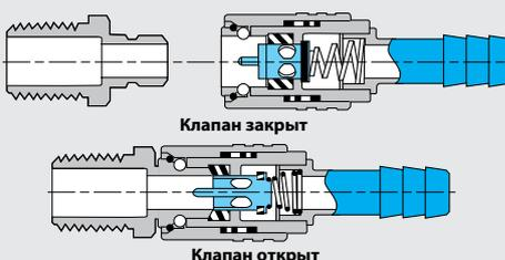
Муфты Jiffy-Tite и Jiffy-Matic могут использоваться взаимозаменяемым образом с одними и теми же штуцерами Jiffy-Tite, уже установленными в вашу пресс-форму или форму для литья под давлением. Муфты обоих типов со сравнимыми размерами имеют один и тот же внешний диаметр, что позволяет менять их одни на другие, даже когда штуцеры установлены заподлицо
